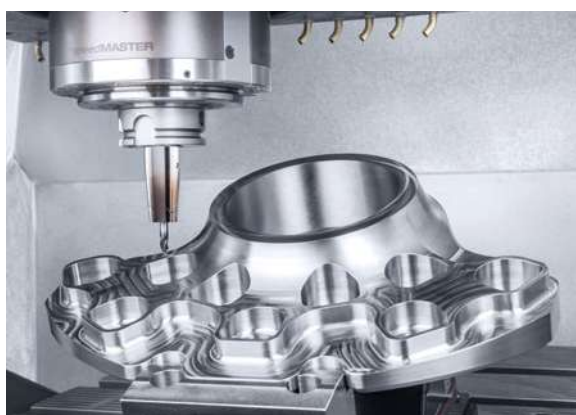
2: Vřeteno motoru SK 40 20 000 ot./min 130 Nm | 35 kW (40 % DC)
