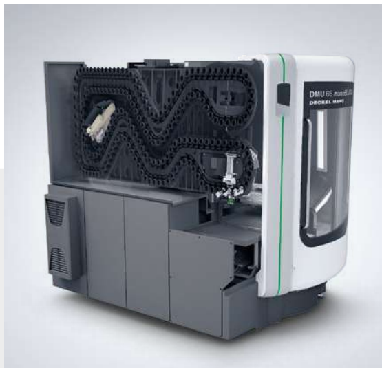
1:Dvojité chapadlo2:integrovaný řetězový zásobník se 120 stanicemi bez dalších nároků na prostor
