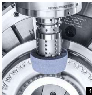
1: Detekce součástí prostřednictvím zatížení vřetena 2: Senzor akustické emise pro oblékání
