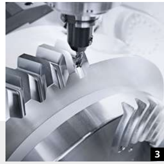
1: Otáčení 2: Klepnutím 3: Frézování ozubení standardními nástroji
