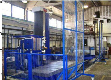
Dieser Die Lösung besteht darin, den gesamten Raum mit einer Schutzmembran zu umgeben gegen das Verschütten von Flüssigkeiten auf dem Werkstattboden, die Schäden verursachen können.
