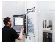
Backup (Standby) Magazin für 180 Werkzeuge
