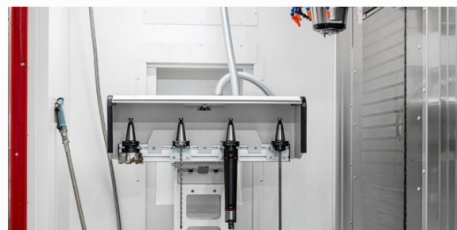
PICK-UP-Magazin zum automatischen Wechseln von großen oder langen Werkzeugen
