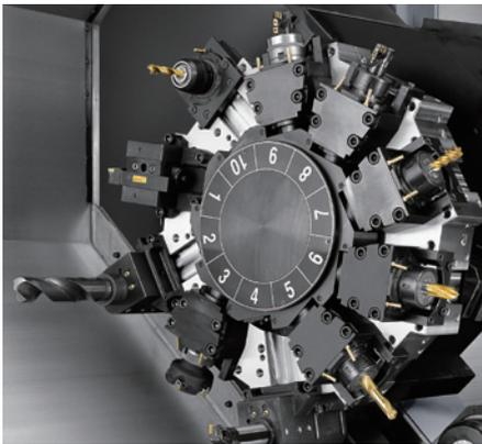
Einmaliges Aufspannen erlaubt das Drehen, Fräsen, Bohren oder Gewindeschneiden.
