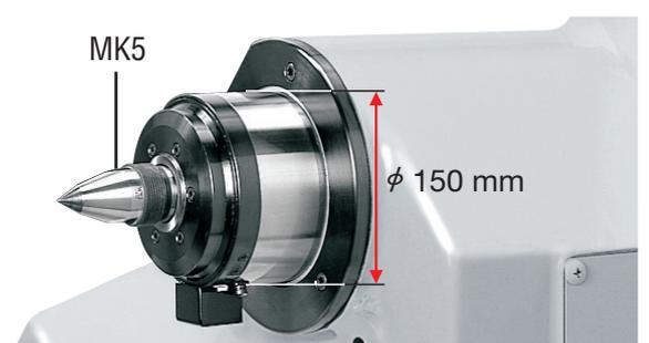
Ein besonders starrer eingebauter Reitstock stabilisiert lange und große Werkstücke.
