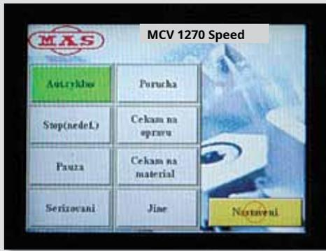
Die Option MAS MACHINE MONITOR ist MAS GSM MONITOR-Setzen ausgewählter Maschinenzustände über das Netz des Mobilfunknetzbetreibers an ausgewählte Telefonnummern in Form einer SMS-Nachricht. Der Werker kann somit sofort auf das Ereignis reagieren, auch wenn er gerade nicht an der Maschine anwesend ist.
