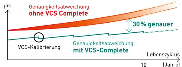
Vergleich der Genauigkeitsabweichung über den Lebenslauf einer Werkzeugmaschine mit und ohne VCS-Complete. Zusätzlich zur erstmaligen Genauigkeitsoptimierung, kann die Genauigkeit der Maschine mit jeder VCS-Kalibrierung über den Lebenslauf optimiert werden.
