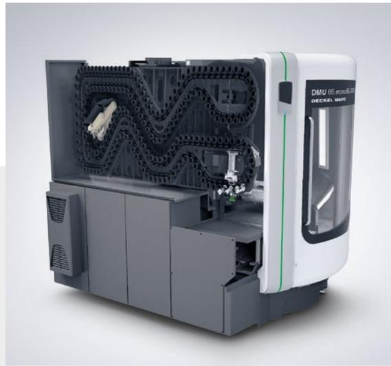
1: Doppelgreifer 2: Integriertes Kettenmagazin mit 120 Plätzen ohne zusätzlichen Platzbedarf
