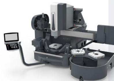
Maschine unverkleidet mit Shuttle-Einheit
