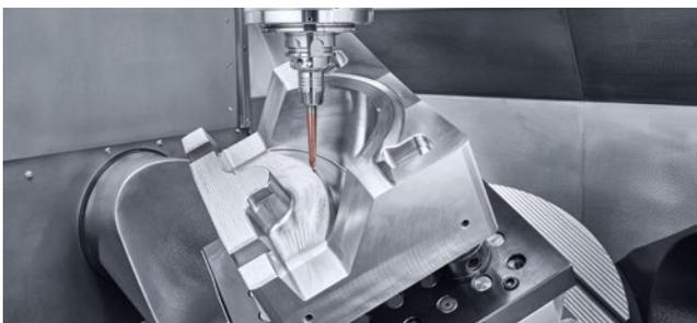
**DAUERGENAU | SCHWENKRUNDTISCH MIT DIRECT DRIVE IN C-ACHSE\***
