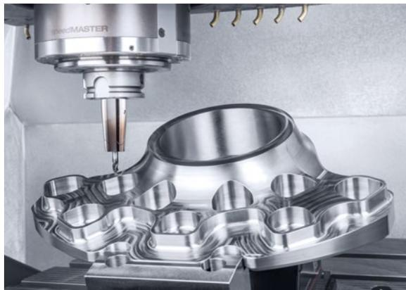
2: Motorspindel SK 40 20.000 min<sup>-1</sup> 130 Nm | 35 kW (40 % ED)
