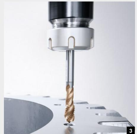
Motorspindel speedMASTER 20.000 min<sup>-1</sup> / 35 kW / 130 Nm
